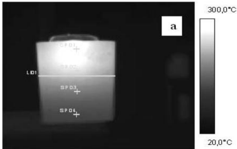
شکل ۱۶ تصویر حرارتی کامپوزیت Ak12/SiC+C در قالب گرافیتی
