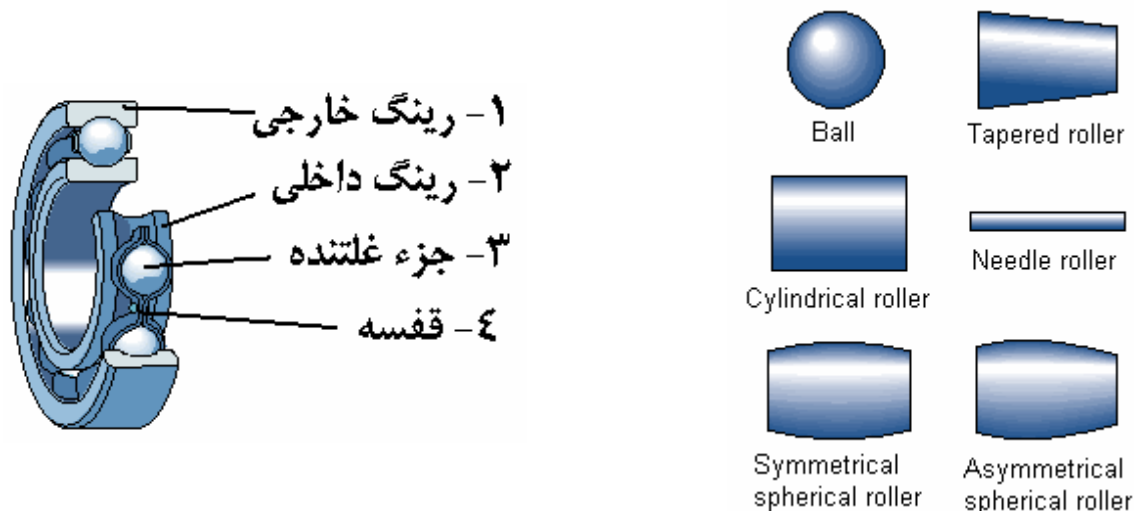
شکل ۱۳- اجزاء عمومی بلبرینگ غلتشی و انواع اجزاء غلتنده
