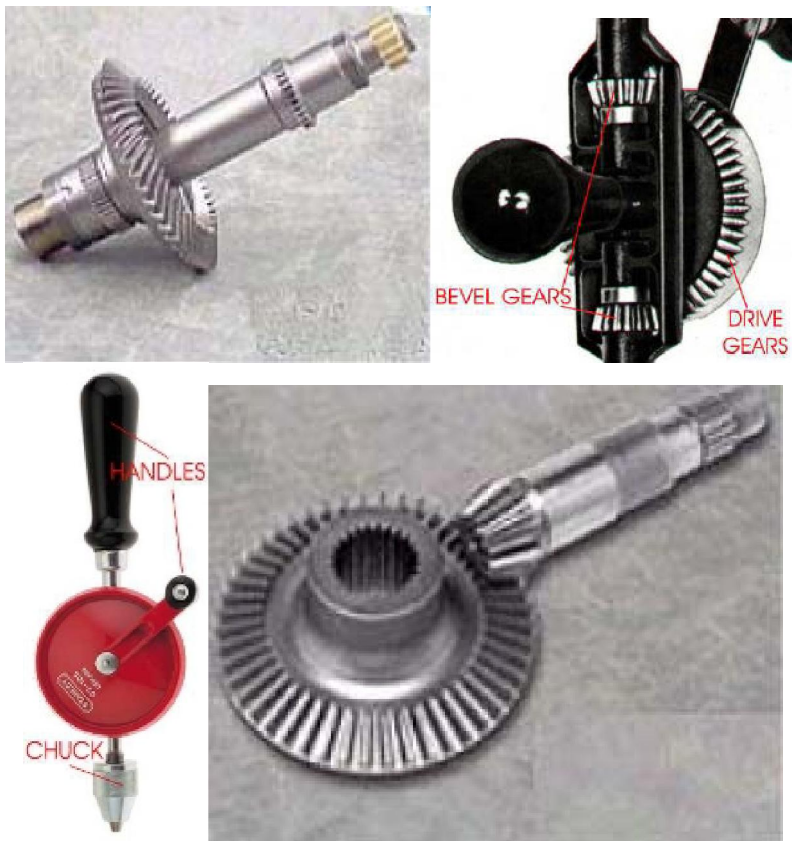
شکل ۲-۲۳ استفاده از چرخ دنده مخروطی برای تولید گشتاور
