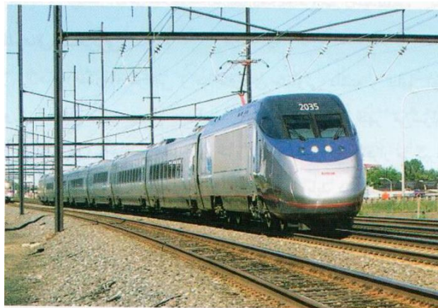
شکل ۵-۱۶ ترن سریع‌السیر Acela مجهز به سیستم کج‌شونده در پیچ‌ها
