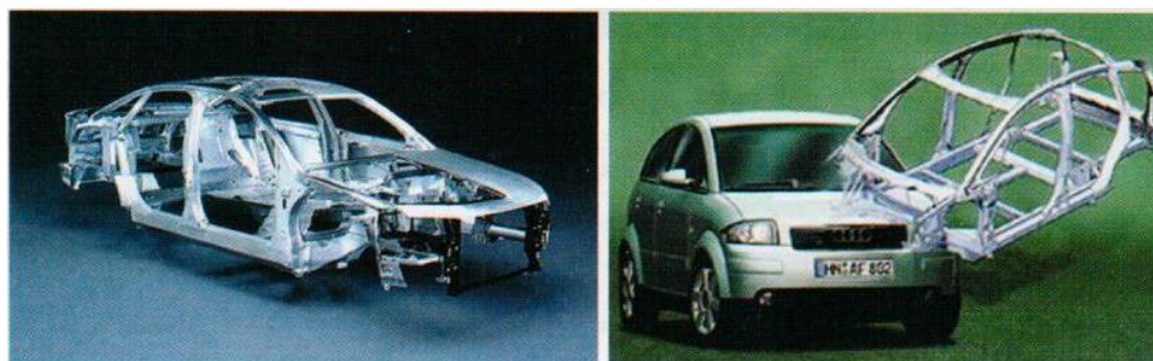
شکل ۵-۱۵ بدنه آلومینیومی Audi A8
