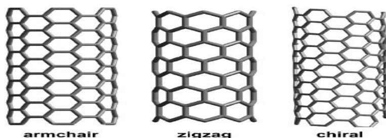
شکل ۲-۷- تفاوت شکل ظاهری نانو لوله های صندلی، زیگزاگ و کایرال
