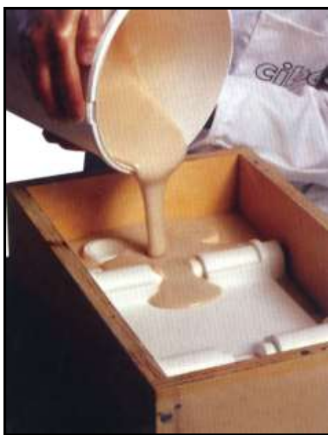
شکل ۲-۱۵- رزین ریخته گری اپکسی در حال ریختن روی مدل
