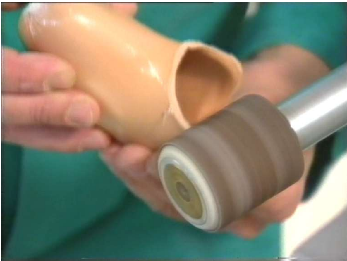
شکل ۴-۵- عملیات ماشین کاری روی پایه اولیه
