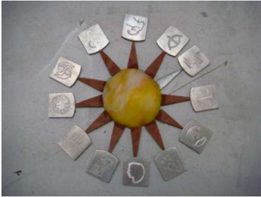
شکل ۳-۳- نحوه قرار گرفتن مدله به همراه سیستم راهگاهی روی میز کار
