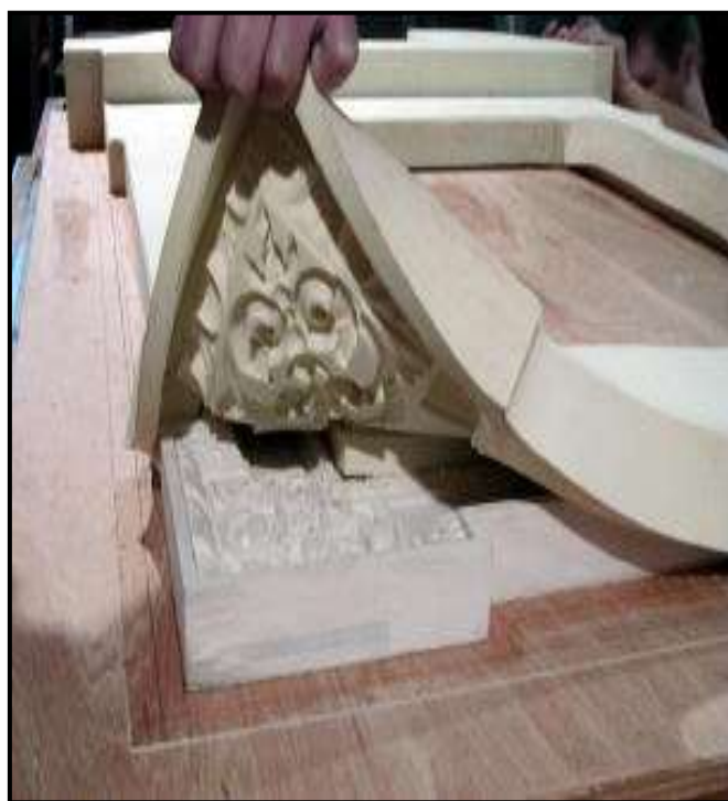
شکل ۲-۱۶- قالب سیلیکونی روی نقش برجسته یکطرفه سیلیکن
