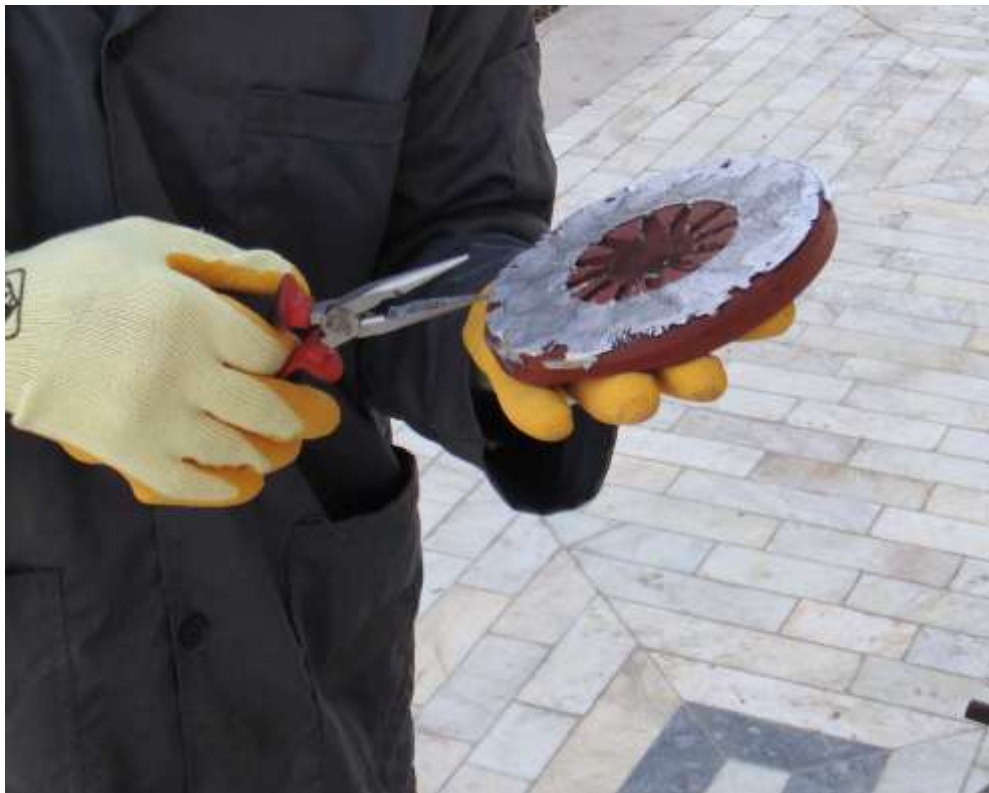
شکل ۳-۱۰- باز کردن قالب و خارج کردن نقش برجسته نهایی
