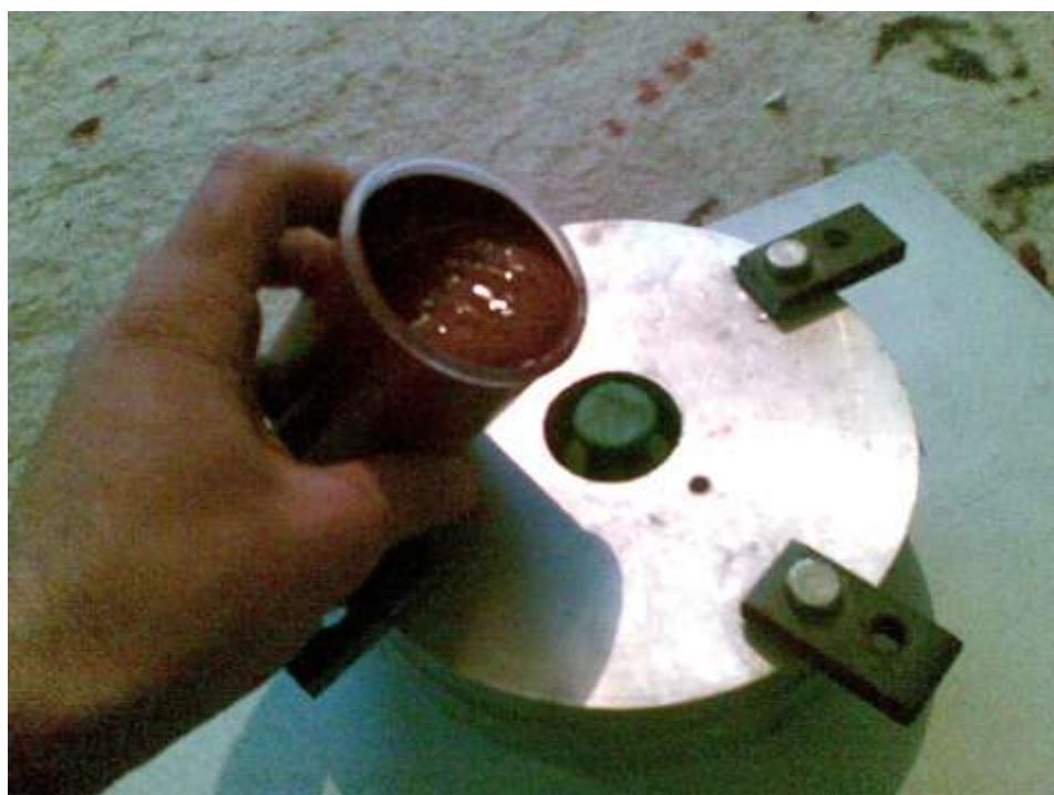
شکل ۳-۶- قرار دادن درجه رویی قالب و فیکس کردن آن و ریختن سیلیکون
