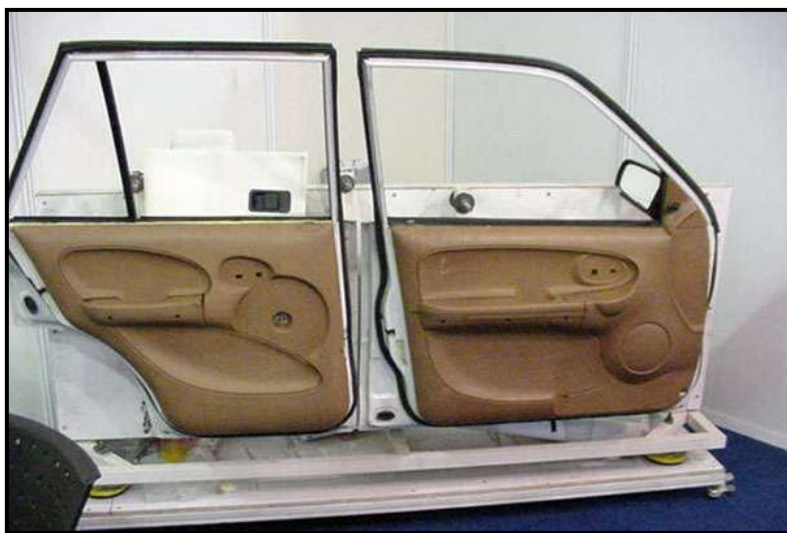
شکل ۲-۱۲- مدل سازی قسمت داخلی درب اتوموبیل با استفاده از رزین لایه گذاری
