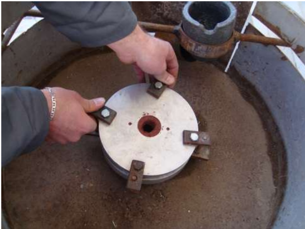
شکل ۳-۸ - دوباره سوار کردن درجه ها روی یکدیگر
