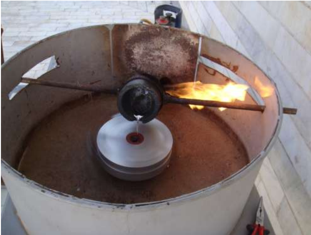
شکل ۳-۹- ریختن مذاب باسیستم چرخشی قالب
