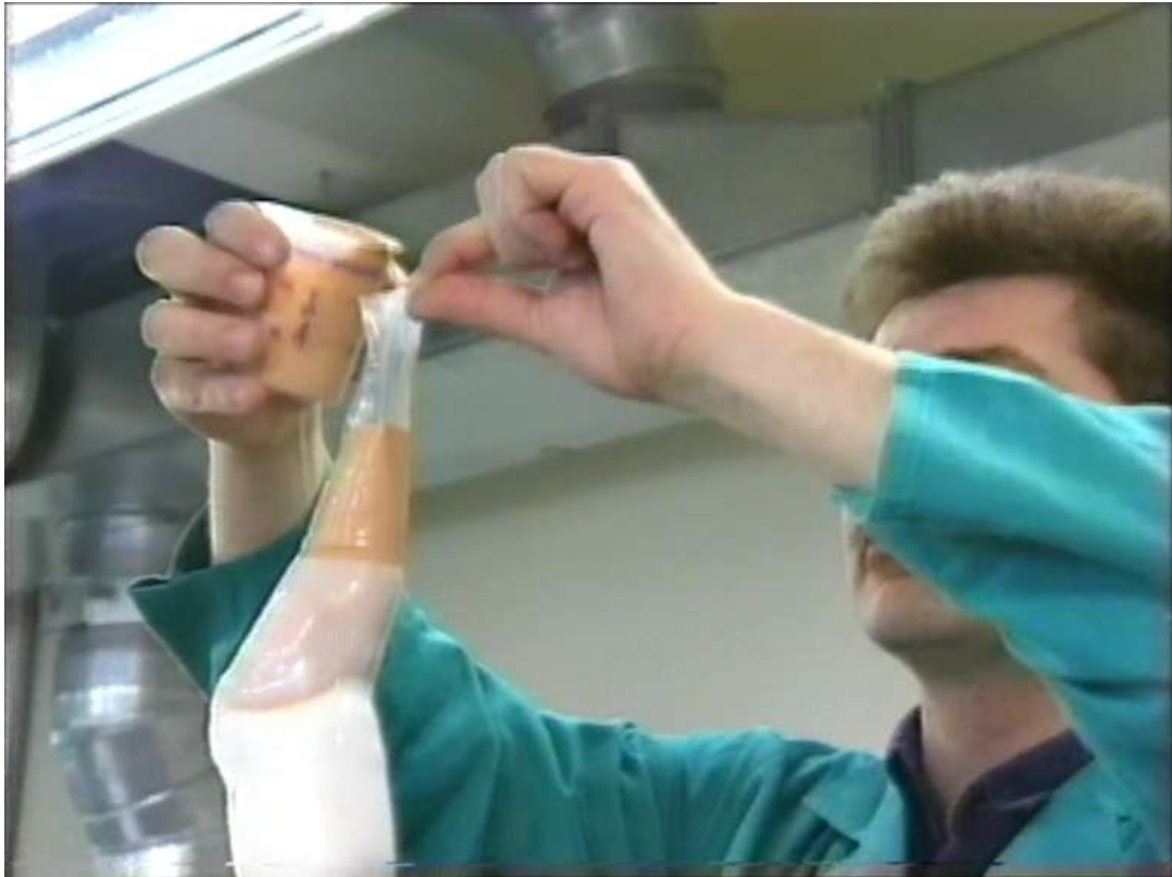
شکل ۳-۴ - مدل گچی بر روی پایه در حال ریختن دوغاب سیلیکون
