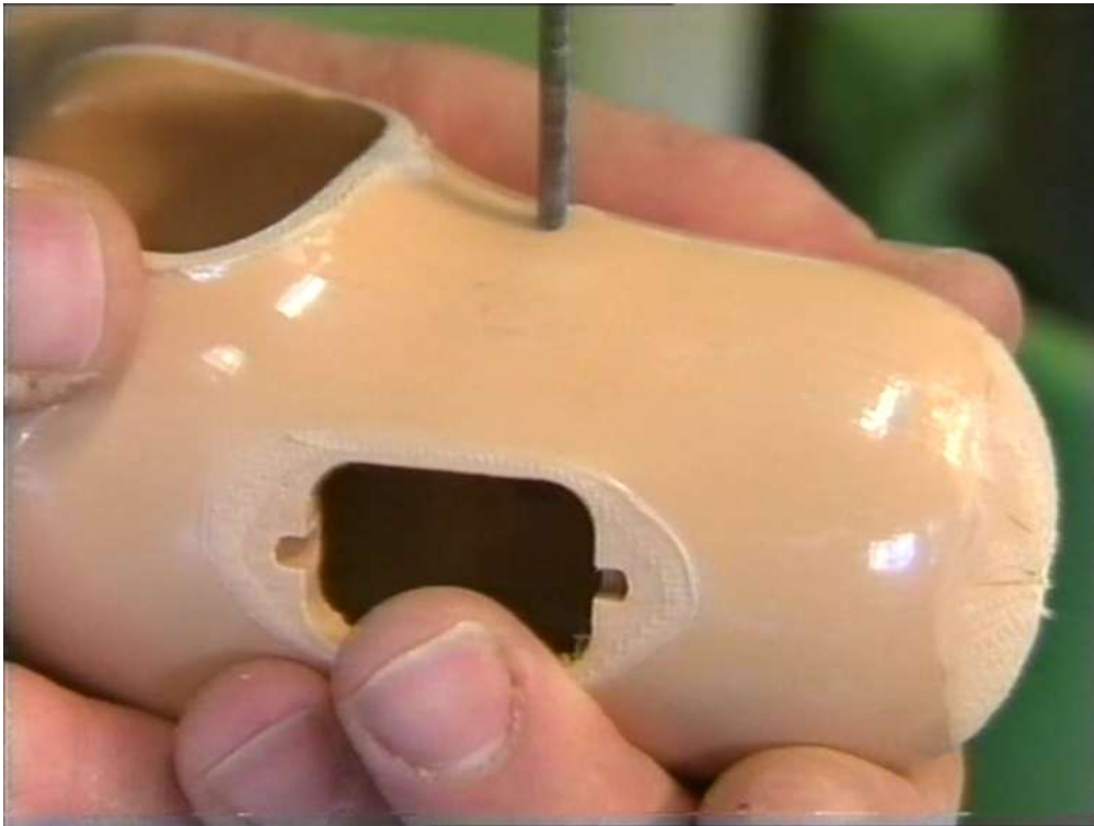
شکل ۴-۵۵- عملیات ماشین کاری برای تعبیه محل الکتروود در پایه دست
