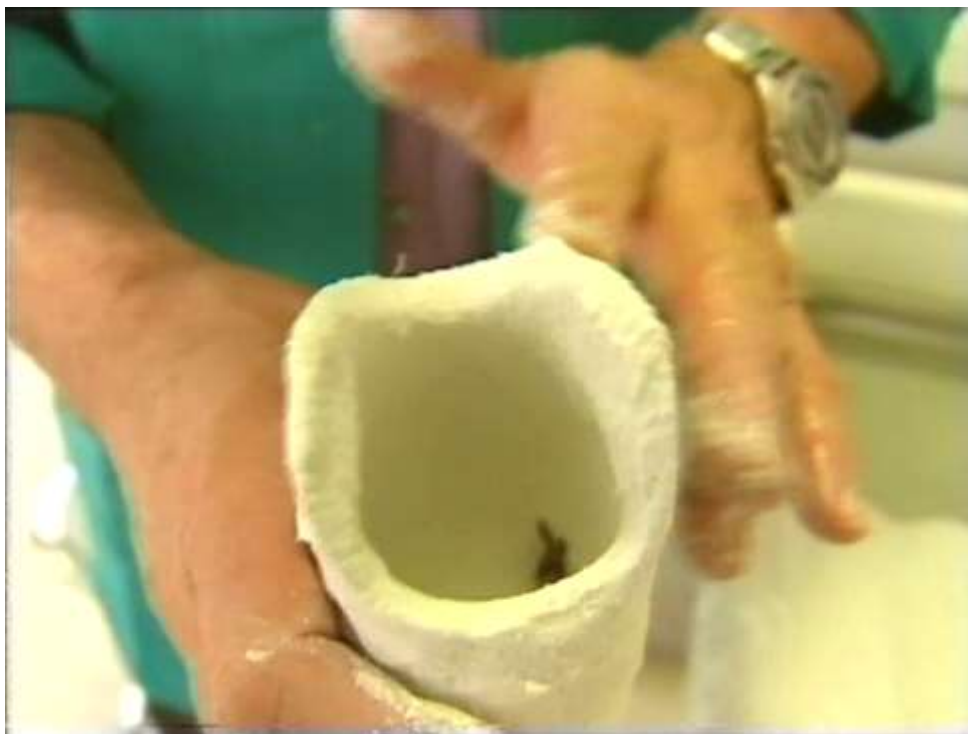
شکل ۴-۲- قالب گچی تو خالی که داخل آن گچ مجسمه سازی ریخته میشود
