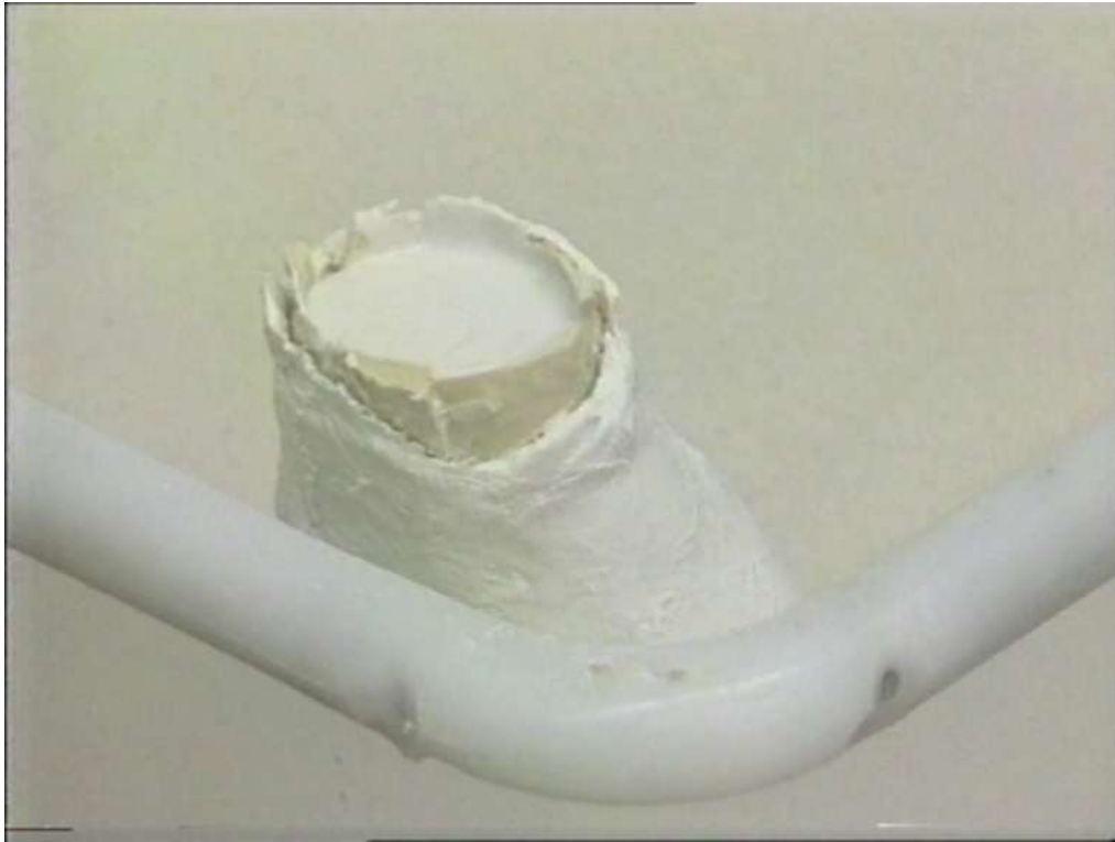
شکل ۴-۸- گچ مجسمه سازی در حال خشک شدن درون قالب
