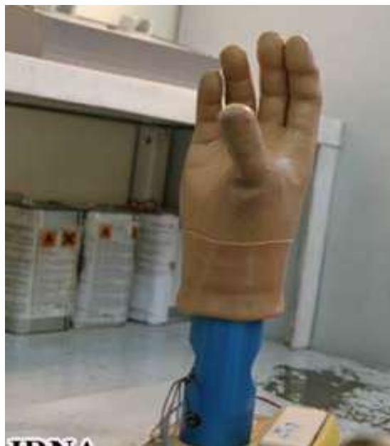
شکل ۲-۲- قسمت بدنه یک دست مصنوعی با روکش نیمه
