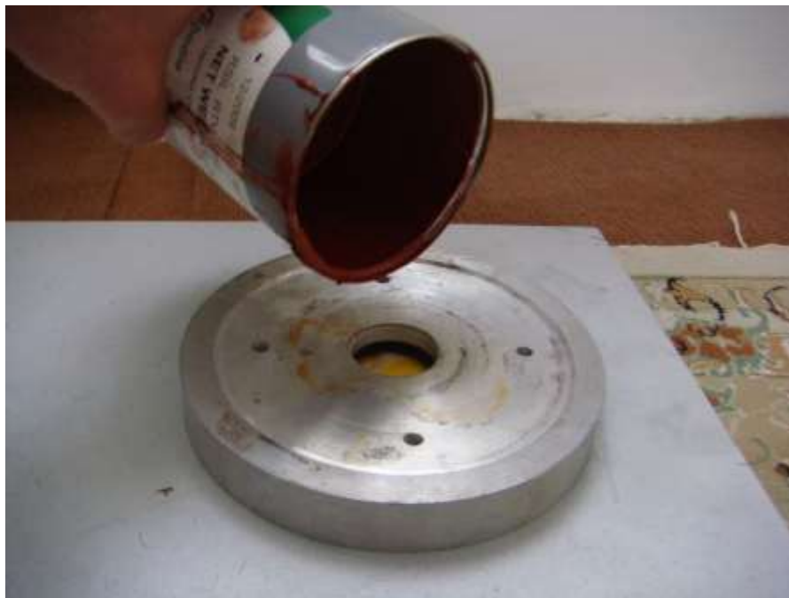
شکل ۳-۴- قرار گرفتن درجه زیرین روی مدل ها و ریختن سیلیکون
