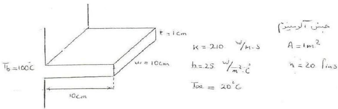
فین از نوع حالت کوتاه است چون طول محدود است لذا تنها از فین در حالت عایق می‌توان استفاده نمود.
