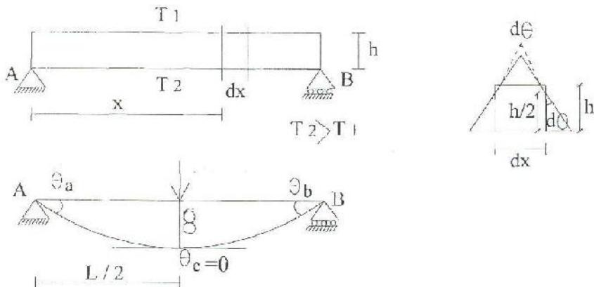
$$\frac{d\theta}{h} = \frac{\alpha(T_2 - T_1)}{h} dx \quad \text{دوران سطوح تیر}$$
