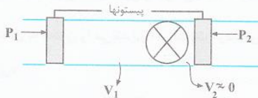
شکل ۲. سیستم در نظر گرفته شده برای حل مسأله. شکل سمت چپ حالت اولیه و شکل سمت راست حالت نهایی را نشان می‌دهد.
