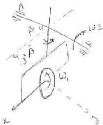
$$\vec{\omega}_{\text{wheel}} = \vec{\omega}_1 + \vec{\omega}_2 + \vec{\omega}_3$$
