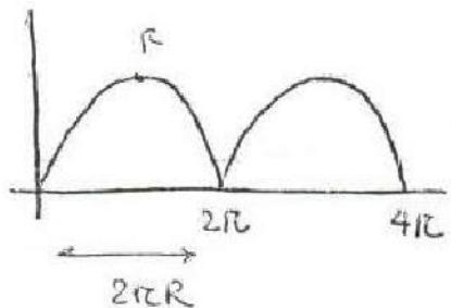
$$\vec{v}_P = \vec{v}_G + \vec{\omega} \times \vec{r}_{P/G} = \dot{x} \hat{i} + \vec{\omega} \times \vec{r}_{P/G}$$
