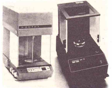
ترازوهای جدیدی که وزن اجسام را با دقت 1 \text{ mg} به دست می‌دهند. سمت چپ: ترازوی یک کفه‌ای شیمی تجزیه. سمت راست: ترازوی برقی قابل اتصال به سایر دستگاه‌ها.
