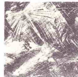
بلورهای فلزی، سطح قطعه‌ای روی که نشان‌دهنده ساختار بلوری آن است.
