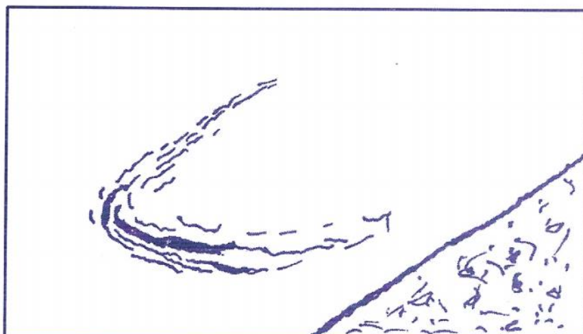
شکل ۳ نمونه‌ای از ترکهای هلالی شکل.
