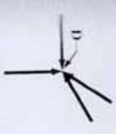
(a) سه جزیه فشاری، مدل در یک ناحیه گرهی
