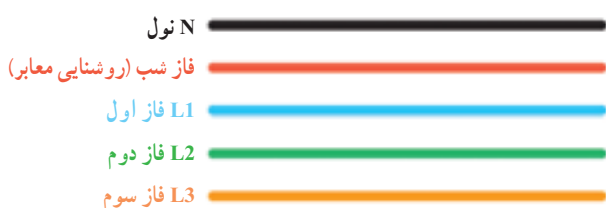
▲ شکل ۱-۶- نامگذاری سیم‌های تیر چراغ برق
