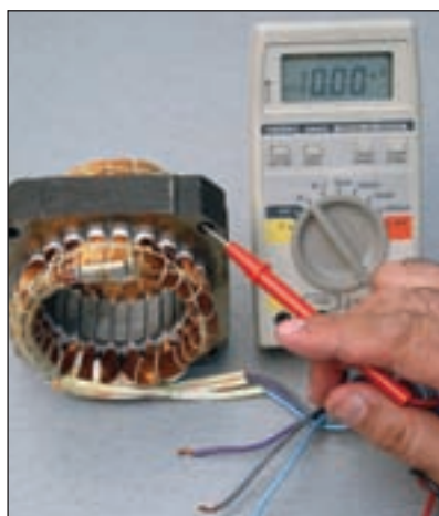
▲ شکل ۱۴-۲- تست اتصال بدنه
