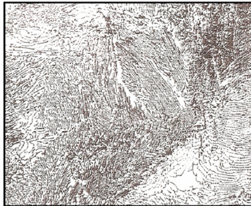
شکل A میکروساختار پرلیت مربوط به آلیاژ ۰.۷۵٪C-Fe که پس از استنیتته شدن در کوره سرد شده است. محلول حکاکی، پیکرال، بزرگنمایی، \times 500
