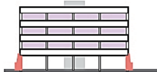
پ- اضافه کردن دیوار حائل
