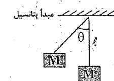
برخورد گلوله با آونگ بالستیک طبق توصیف مسئله کاملاً غیرکشسان است. انرژی جنبشی سیستم در حالت اولیه  $\frac{1}{2}mv^2$  است و در حالت نهایی صفر، انرژی پتانسیل سیستم در حالت اولیه  $(m + M)g\ell \cos\theta$  و در حالت نهایی  $(m + M)g\ell$  (توجه کنید که گلوله در آونگ فرو رفته است)
