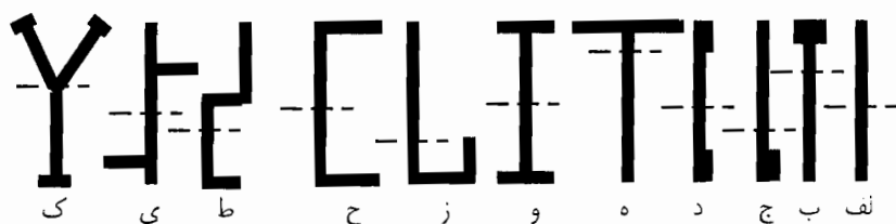
شکل ۲-۴. مقاطع متداول در دیوارهای برشی طره‌ای
