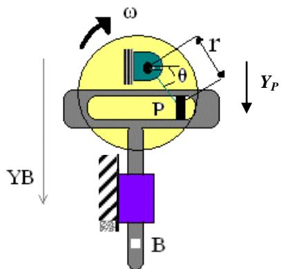
**مثال 5-12:** میله T شکل توسط یک پین به دیسکی که با سرعت زاویه‌ای  $\omega$  و شتاب زاویه‌ای  $\alpha$  درحال حرکت است متصل شده است. فاصله پین تا مرکز دیسک برابر  $r$  می‌باشد.
