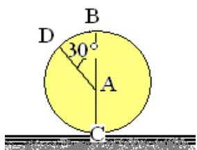
**مثال 5-6:** اتومبیلی با سرعت ثابت  $50 \text{ km/h}$  در حال حرکت به سمت راست می باشد . اگر قطر چرخهای اتومبیل  $610 \text{ mm}$  باشد ، مطلوب است ، سرعت نقاط
