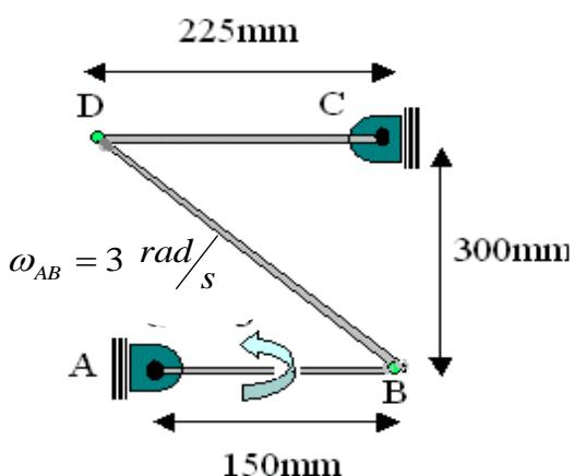
**مثال ۵-۴:** اگر در حالت نشان داده شده سرعت زاویه‌ای برابر  $3 \text{ rad/s}$  باشد، مطلوب است:  $\omega_{BD}, \omega_{DC} = ?$
