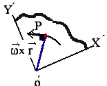
$$V_{P/O'} = \vec{\omega} \times \vec{r} \quad , \quad \vec{r}' = \vec{V}_{rel} = \vec{V}_P - \dot{R}$$
