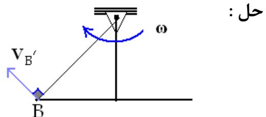
$$\vec{V}_B = \vec{V}_{B'} + \vec{V}_{B/B'} \Rightarrow \vec{V}_B = \vec{V}_{B'} + \vec{V}_{BE/CD}$$
