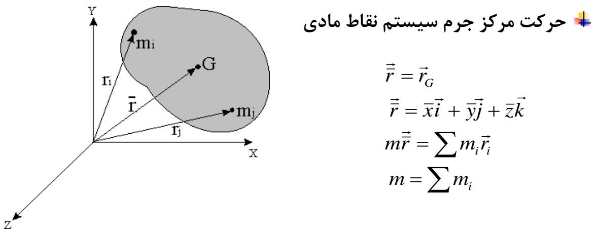
$$\rightarrow \bar{x} = \frac{1}{m} (\sum m_i x_i), \bar{y} = \dots, \bar{z} = \dots \quad \text{موقعیت مرکز جرم :}$$
