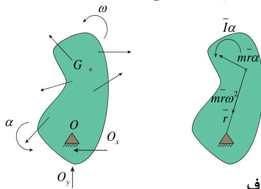
$$\begin{aligned} (\sum M_o) &= (\sum M_o)_{\text{eff}} && \text{حذف می‌شود: } O_y, O_x \\ (\sum M_o) &= (\bar{I} + m\bar{r}^2) \alpha && \text{(انتقال ممان)} \\ \Rightarrow \sum M_o &= I_o \alpha \end{aligned}$$
