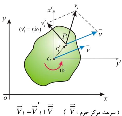
$$\vec{V}_i = \vec{V}'_i + \vec{V} \quad (\vec{V} : \text{سرعت مرکز جرم})$$
