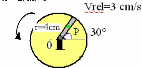
$$\vec{V} = \vec{R} + \vec{\omega} \times \vec{r} + \vec{r}' \quad (\vec{R} = 0)$$
