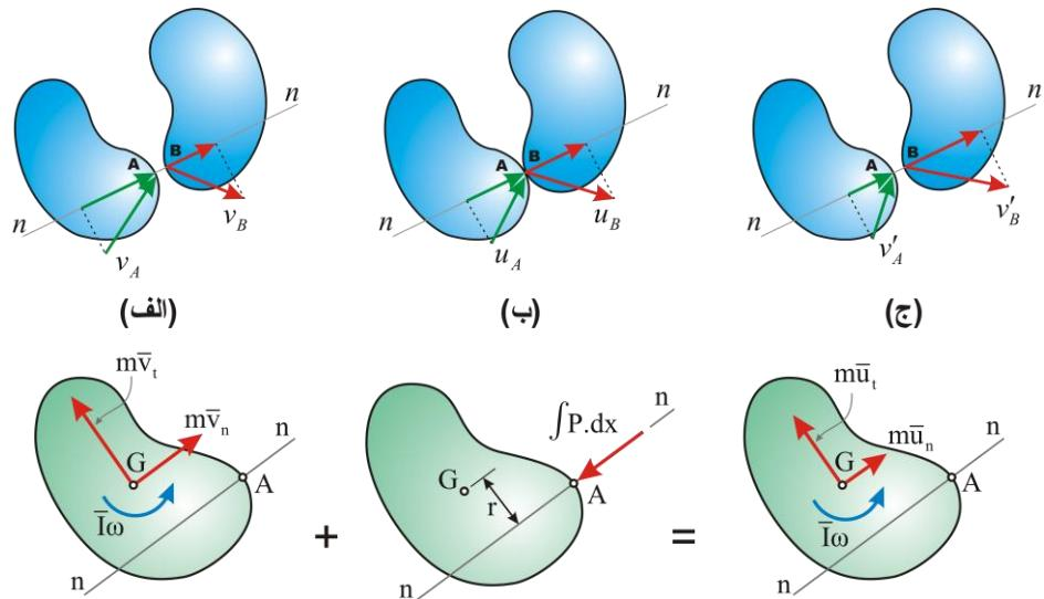
سرعت قبل از برخورد :  $\bar{V}_A, \omega_A, \bar{V}_B, \omega_B$
