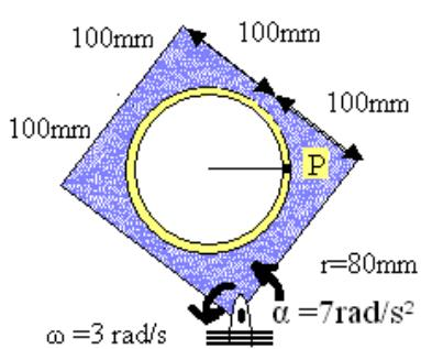
**مثال ۱۸-۵:** اگر جرم P در داخل شیار دایره‌ای شکل با سرعت زاویه‌ای  $\dot{\beta} = 5 \text{ rad/s}$  نسبت به مرکز صفحه و شتاب زاویه‌ای  $\ddot{\beta} = 12 \text{ rad/s}^2$  در حال دوران باشد مطلوبست :
