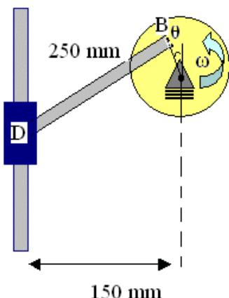
**مثال ۵-۵:** اگر یک دیسک با سرعت زاویه‌ای ثابت  $\omega = 500 \text{ rpm}$  در حال دوران باشد، مطلوب است: سرعت طوقه D در حالت فاصله نقطه B تا مرکز دیسک 50 mm می باشد)
