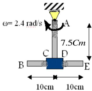
**مثال ۱۹-۵ :** اگر  $V_{BE/CD} = 15 \text{ cm/s}$  باشد آنگاه سرعت و شتاب نقطه B چقدر است؟
