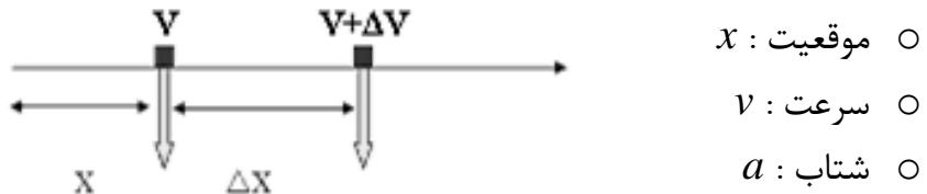
$$\bar{a} = \frac{\Delta v}{\Delta t} = \frac{(v + \Delta v) - v}{(t + \Delta t) - t} : \text{شتاب متوسط}$$
