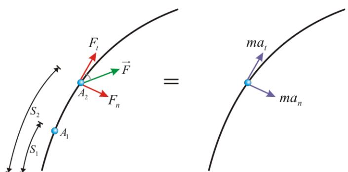
**مثال 3-1 :** در شکل، اگر گلوله از وضعیت 1 رهاشده باشد، سرعت آنرا در وضعیت 2 بیابید.
