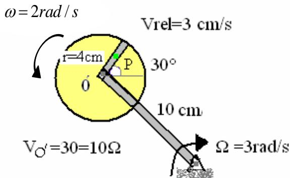
$$\vec{V}_p = \vec{V}_{O'} + \vec{V}_{p/O'} + V_{p/p'} = V_{O'} + \vec{\omega} \times \vec{r} + \vec{V}_{rel}$$
