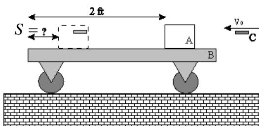
**مثال 4-2:** گلوله C با سرعت  $v_0$  به سمت جسم A شلیک می‌گردد و در آن فرو می‌رود و باعث حرکت جسم A روی گاری B و حرکت گاری می‌گردد. مطلوب است :
