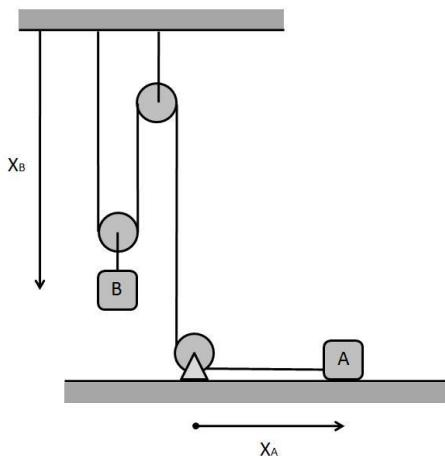
$$\begin{aligned}x_B + x_B + C_1 + x_A &= cte \\x_A + 2x_B &= cte \\V_A + 2V_B &= 0 \\a_A + 2a_B &= 0\end{aligned}$$
