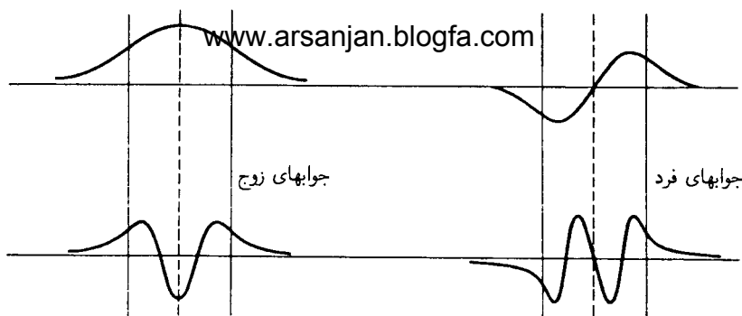
شکل ۵-۱۰ جوابهای مربوط به طیف گسسته در چاه پتانسیل جاذب.
