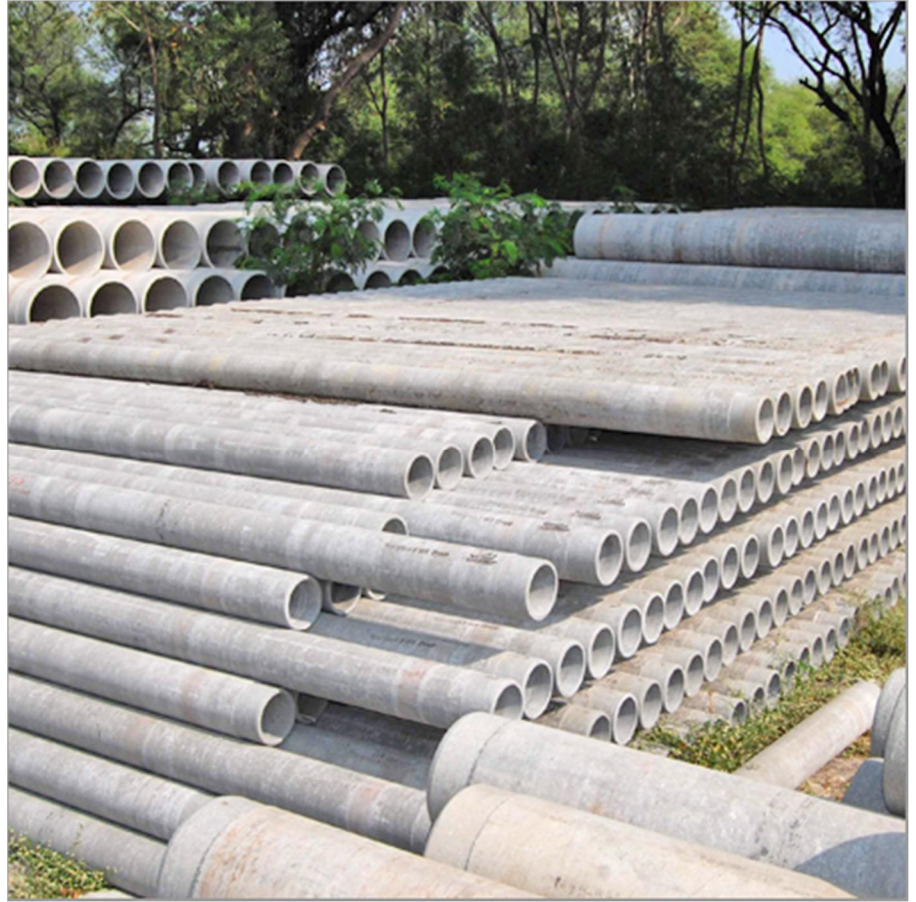
شکل ۱- لوله های آزبست سیمان
