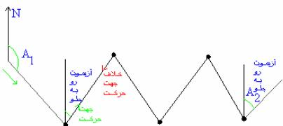
برای بالا رفتن دقت کار زاویه افقی دوبار اندازه گیری
