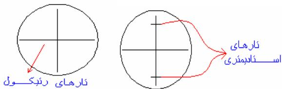
وقتی عدسی شبیه تنظیم شده باشد تصویر ممیز جسم (وی صفحه ریکول تشکیل می شود.
