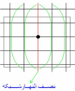
بگیرید. می توان فرض کرد که در این منطقه کلیه نصف النهارها به موازات این نصف النهار می باشد و کلیه مدارها نیز عمود بر این نصف النهار فواهد بوداین نصف النهار که بر اساس آن یک شبکه مختصات ساقته می شود نصف النهار شبکه می نامند.
