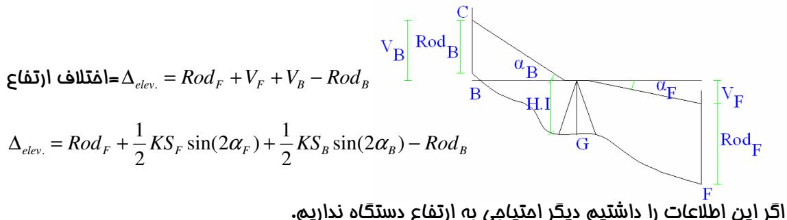
مزیت روشن دوچ نسبت به روشن اول دراین است که تنظیم کردن روی یک نقطه مشخص لازم نیست و مزیت دیگر این که در فرمول بدست آوردن HI یا اندازه ارتفاع دستگاه لازم نیست.
