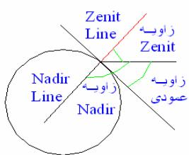
$$\left\{ \begin{array}{l} \text{زاویه بین سه زاویه} \\ \text{Zenit + Vertical} = 90^\circ \\ \text{angle angle} \\ \text{Nadir - Vertical} = 90^\circ \\ \text{angle angle} \\ \text{Nadir + Zenit} = 180^\circ \end{array} \right.$$
