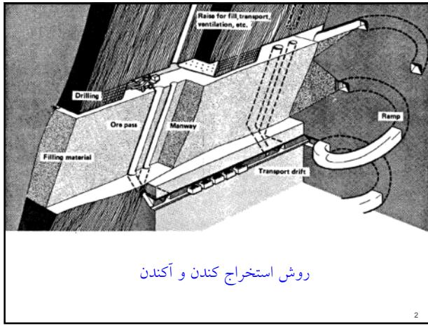
**(Cut and fill)** روش کندن و آکندن به صورت بالادستی و پایین دستی بکار گرفته می شود که طی آن برش هایی از ماده معدنی جدا شده و بجای آن خاکریز اضافه می شود. فضای خالی حدود ۳ متر برای کار کردن بدون خاکریز باقی می ماند.
