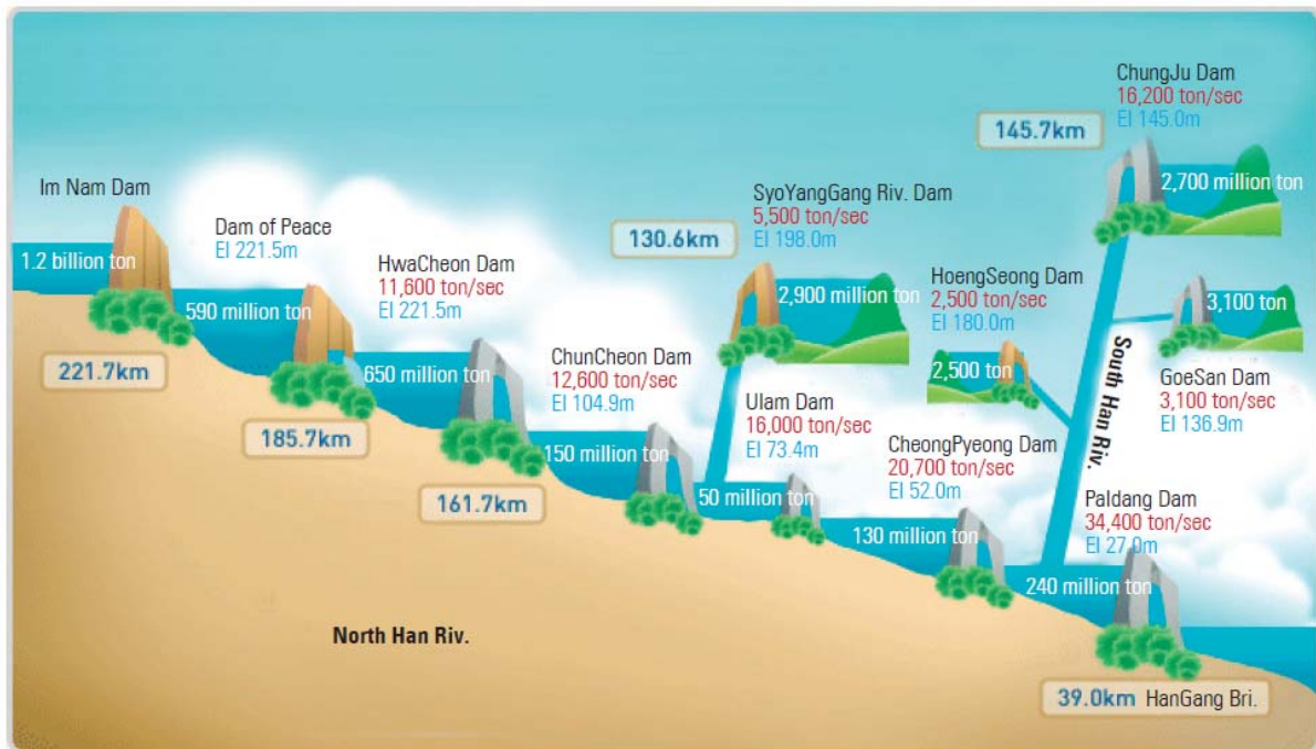
شکل ۱-۲ سیستم چند مخزنی و چند هدفه رودخانه هان کره جنوبی ( Korea Institute of Construction Technology, 2009 )
