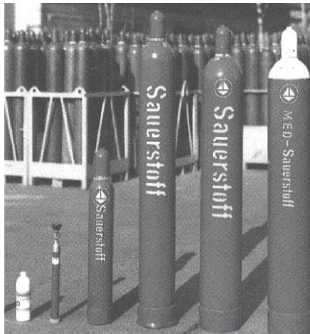
شکل ۴. کپسولهای ذخیره اکسیژن
