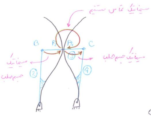
$$\vec{V}_{C_4} = \vec{V}_{B_2} + \vec{V}_{C_3/B_3}$$
