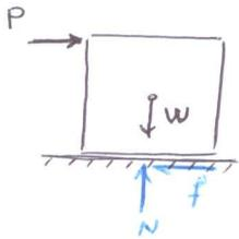
هنگامی که یک جسم روی سطحی قرار دارد، به خاطر نفوذ اتم‌ها و درگیر شدن ذرات، اندکی چسبندگی و جوش خوردن سطحی بین آنها به وجود می‌آید که در نتیجه برای حرکت دادن جسم باید این اصطکاک بسازند. (چسبندگی اصطکاک) یک تماس واقعی داریم و یک تماس ظاهری. وقتی جسم را روی سطح فشار بدهیم، درگیری ذرات با هم بیشتر می‌شود و سطحان دادن جسم سخت‌تر می‌شود. اگر می‌شود که بیشتر از یک باشد.
