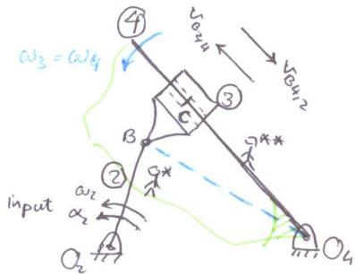
$$* (A_{B_4}^n + A_{B_4}^t) = (A_{B_2}^n + A_{B_2}^t) + [(A_{B_4/2}^n + A_{B_4/2}^t) + A_{B_4/2}^c]$$
