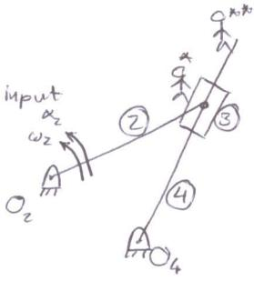
$$* (A_{B_4}^n + A_{B_4}^t) = (A_{B_3}^n + A_{B_3}^t) + [(A_{B_4/3}^n + A_{B_4/3}^t) + A_{B_4/3}^c]$$
