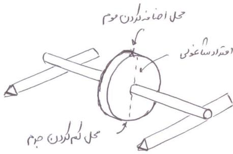
اگر در دورانی متفاوت، بی تفاوت فاند، پس در تمام راستاها بی تفاوت می ماند.
