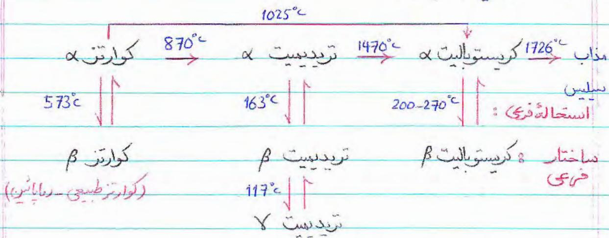
هزاب سیلیس در دمای  $1726^{\circ}\text{C}$  اگر سرد شود به کریستالیت  $\alpha$  تبدیل نمی شود بلکه
