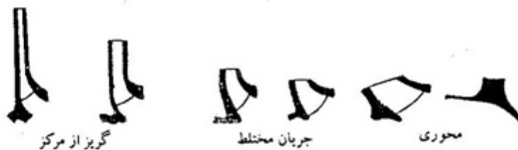
شکل (۲-۳) نمایش نمودار پمپ با سرعت مخصوصهای مختلف
