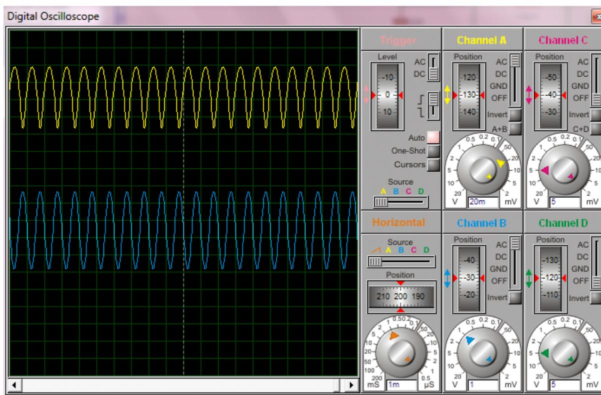
اگر دامنه از ۳۰۰ میلی ولت بیشتر شود، ترانزیستورها به حالت اشباع می رود و موج مربعی می شود.
