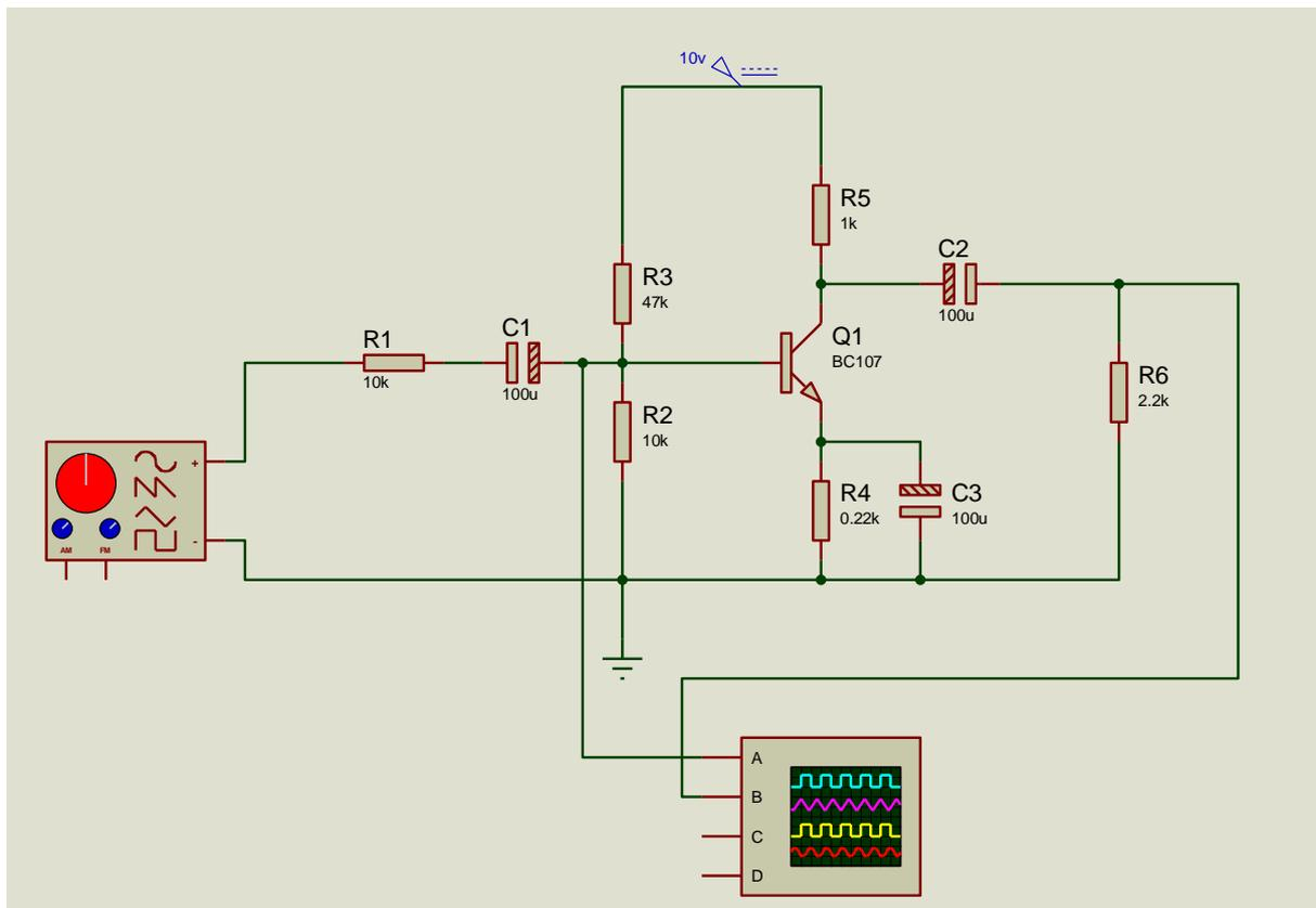
برای اندازه گیری نقطه کار سیگنال ژنراتور را خاموش می کنیم و خازن ها را اتصال باز. سپس مدار را هم از راه تئوری و هم عملی تحلیل dc می نمایم.
