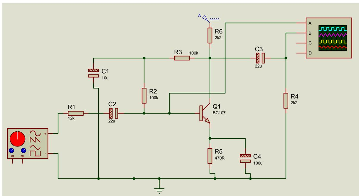
برای اندازه گیری نقطه کار سیگنال ژنراتور را خاموش می کنیم و خازن ها را اتصال باز. سپس مدار را هم از راه تئوری و هم عملی تحلیل dc می نماییم.
