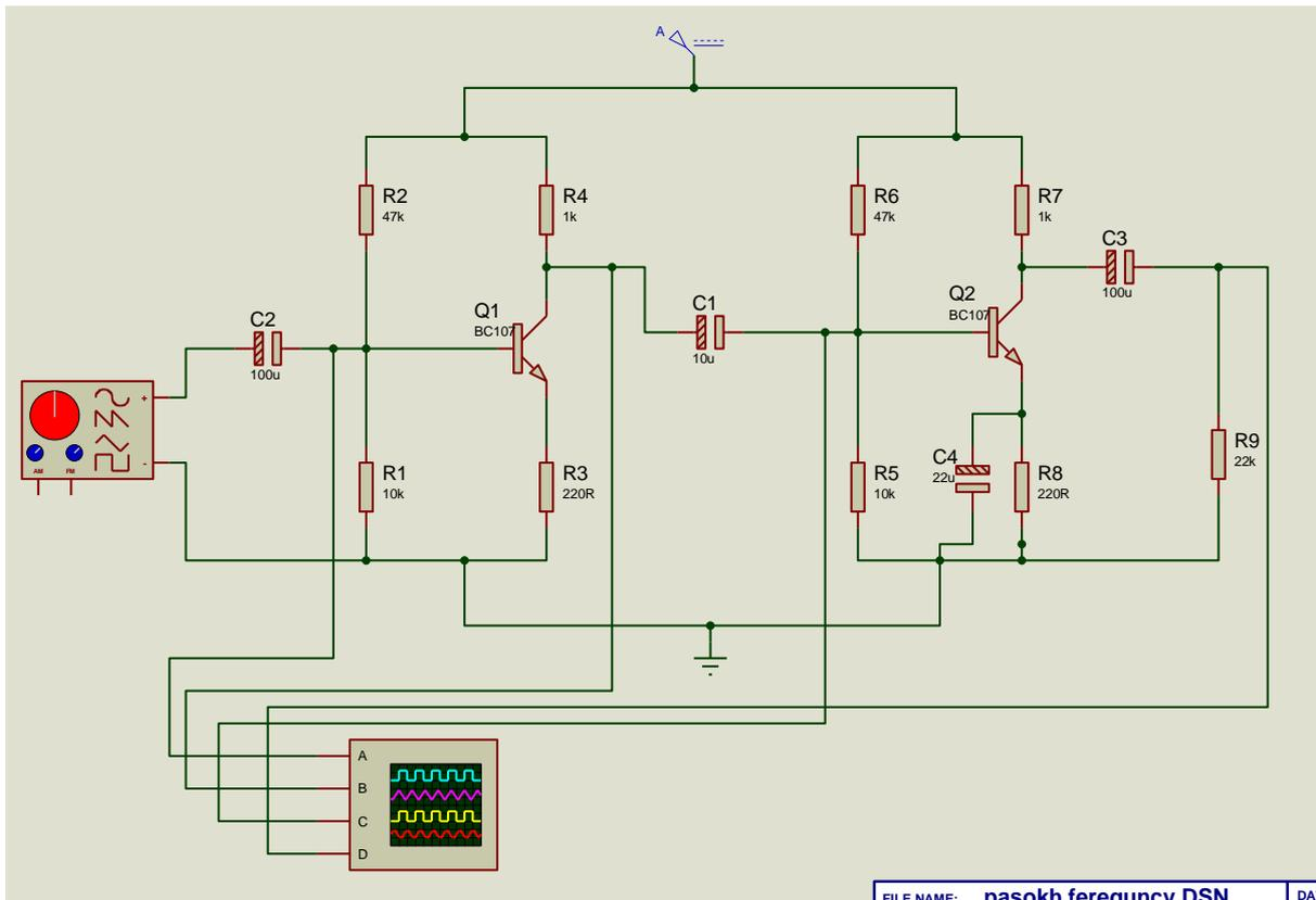
برای اندازه گیری نقطه کار سیگنال ژنراتور را خاموش می کنیم و خازن ها را اتصال باز. سپس مدار را هم از راه تئوری و هم عملی تحلیل dc می نماییم.
