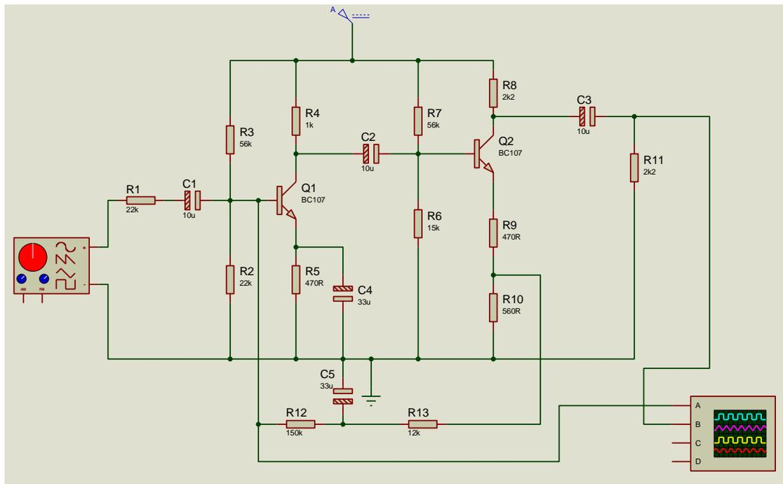
برای اندازه گیری نقطه کار سیگنال ژنراتور را خاموش می کنیم و خازن ها را اتصال باز. سپس مدار را هم از راه تئوری و هم عملی تحلیل dc می نماییم.
