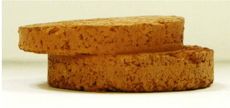
شکل ۸-۵ شکست نمونه پس از پایان آزمایش برش مستقیم
