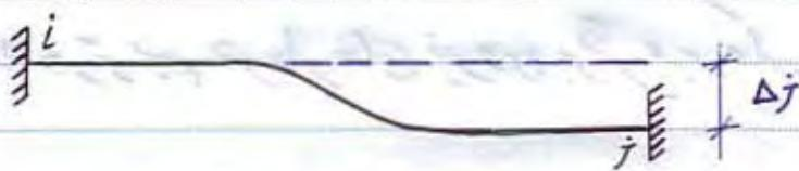
$$M_{ij} = \frac{2EI}{L} (2\theta_i^{\circ} + \theta_j^{\circ} - 3\varphi_{ij}^{\circ}) + (F.E.M)_{ij}$$
