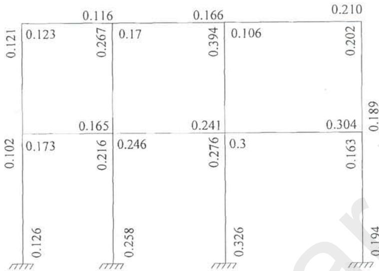
در شکل فوق  $c_{ij}$  و  $g_{ij}$  (ضرایب پخش لنگر ستون‌ها و تیرها) نشان داده شده است.
