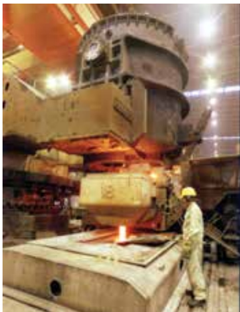
شکل ۸-۱۴- عملیات ذوب‌ریزی از پاتیل حمل مذاب
