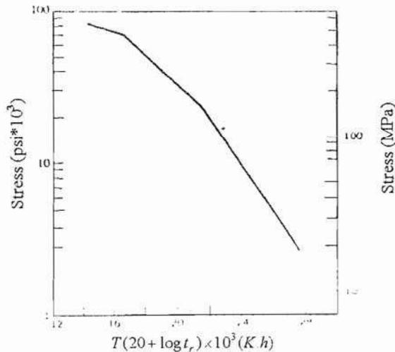
۳-۷- پیچی فولادی در کشش تا 10000Psi بارگذاری می‌شود و اتصال هر دو انتهای آن به صورت صلب است. بعد از سه سال کار در 427°C، تنش موجود در پیچ چقدر است. (σ برحسب Psi و ε° برحسب درصد به ساعت است).
