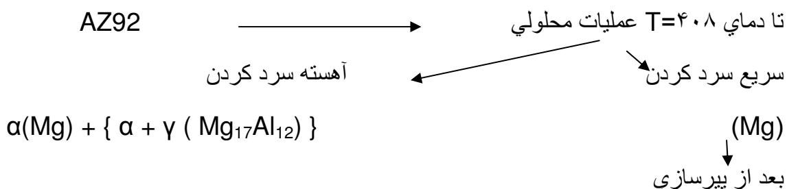
در اثر پیر کردن مصنوعی ترکیبات بین فلزی به صورت ذرات ریز در درون دانه ها رسوب کرده و باعث افزایش استحکام و سختی می شود.
