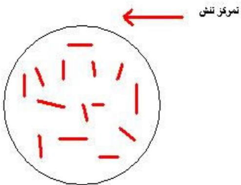
کلیه ترکیبات بین فلزی فاز های ترد ، سخت و شکننده هستند . سختی فاز های سوزنی ۶۰۰-۷۰۰ ویکرز و سختی زمینه  $\text{Al}$  ، ۲۰-۳۰ راکول است . فاز های سوزنی در واقع صفحاتی هستند که از کناره دیده می شوند. با افزودن منگنز مورفولوژی ( شکل هندسی ) فاز های بین فلزی تغییر داده می شود و از اثر مضر آن کاسته می شود.
