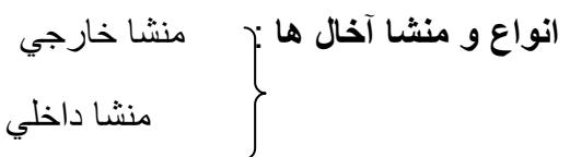
خارجی : مثل شکستن دیواره بوته و یا ماسه شویی و داخل مذاب می شود شامل آلومینا ، سیلیس ، کاربید سیلیسیم . اندازه ذرات می تواند بین  $1\text{ }\mu\text{m-mm}$  باشد.
