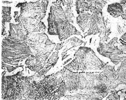
شکل ۲-۱۳ فریت پرویوتکتوئید (نواحی سفیدرنگ) و پرلیت در آلیاژ ۰.۴٪C-Fe که پس از آستنیت‌شدن، در هوا سرد شده است. محلول حکاکی، نایتال. بزرگنمایی \times 500 [۱].
