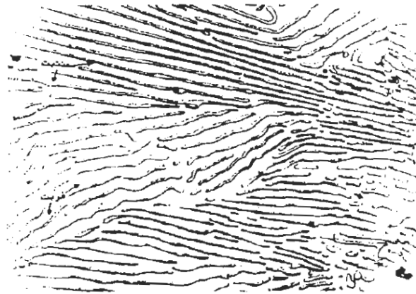
شکل ۲-۳ پربلیت شامل لایه‌های سمنتیت در زمینه‌ای از فریت. بزرگنمایی \times 2500
