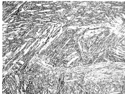
شکل ۸-۷ میکروساختار مارتنزیت لایه‌ای در آلیاژ Fe-1\%C بعد از بازپخت به مدت ۱۵ دقیقه در ۴۰۰ درجه سانتیگراد (۷۵۲ درجه فارنهایت). میکروساختار نوری. محلول حکاکی نایتال. بزرگنمایی \times 500 [۱].
