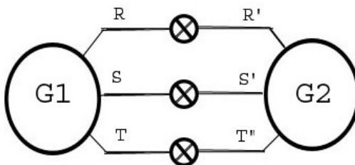
۲) استفاده از لامپ حالت خاموش که در این صورت از مدار شکل ذیل استفاده می‌شود در صورت همفاز بودن، دو لامپ بالائی روشن و لامپ پائینی خاموش خواهد شد (البته در صورت مساوی بودن ولتاژهای ژنراتور).
