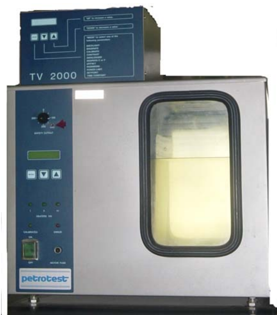
شکل ۲: حمام با دمای قابل تنظیم
