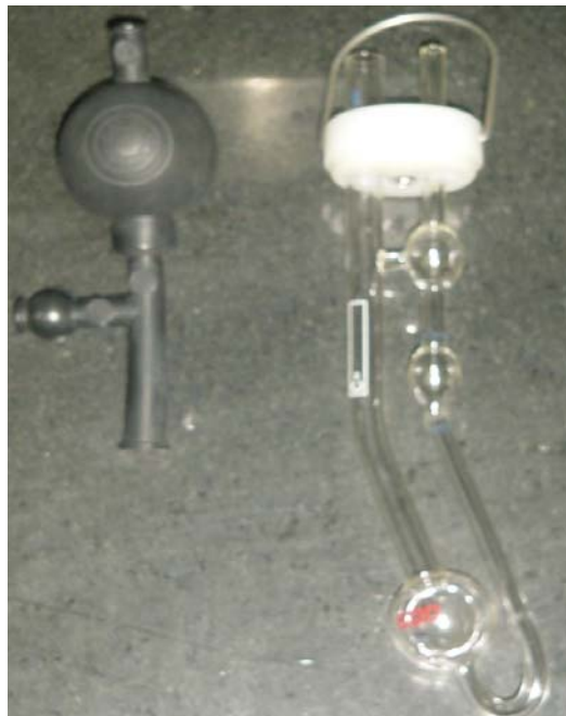
شکل ۱: شکل سمت راست: ویسکومتر، سمت چپ: پوآر
