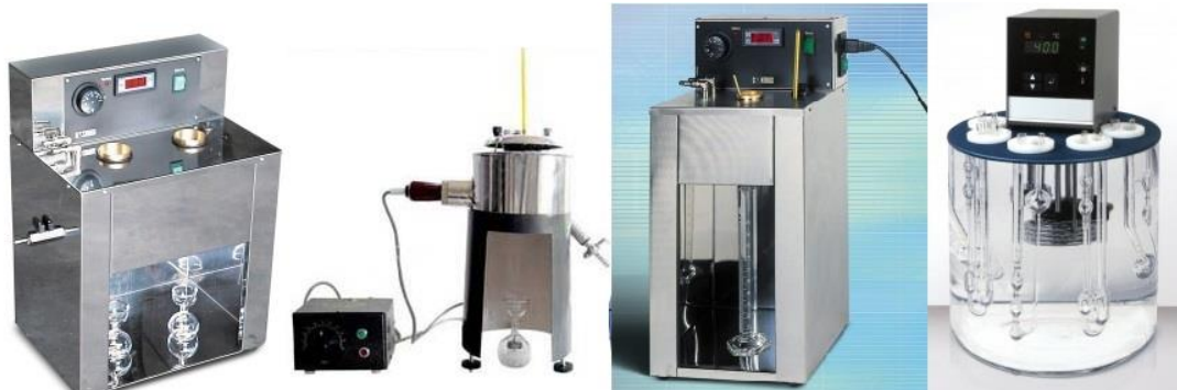
شکل (۱-۱): یکی از انواع دستگاه سنجش ویسکوزیته قیر (از چپ: سی بولت، ردوود، تار، سینماتیکی)
