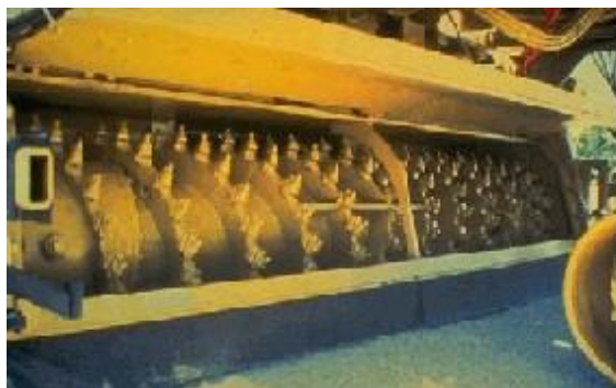
شکل (۷-۱۱): خودروی تولید و تزریق دوغاب سیمان و نمایی از درام تراش آسفالت
