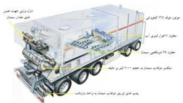
شکل (۷-۱۱): خودروی تولید و تزریق دوغاب سیمان و نمایی از درام تراش آسفالت
