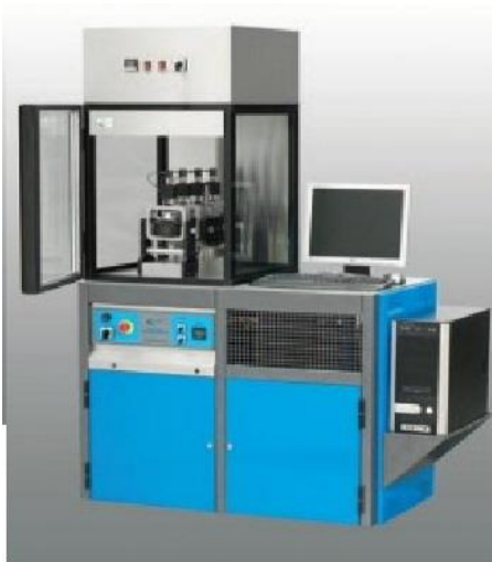
شکل (۴-۱۲): محفظه و فک و مکانیزم بارگذاری آزمایش خستگی خمشی چهارنقطه ای
