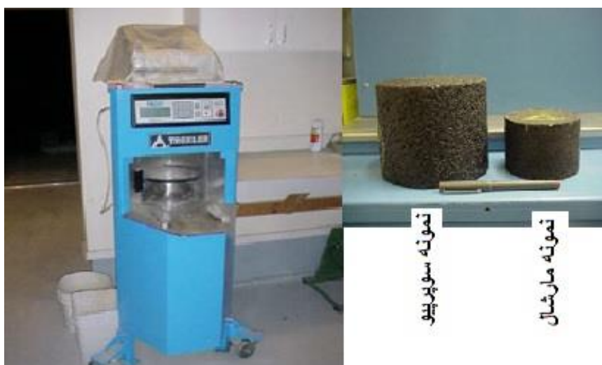
شکل (۳-۲۱): متراکم کننده ژیراتوری و نمونه های مارشال و ژیراتوری
