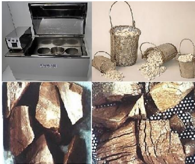
شکل (۲-۱۲): محفظه، سبدهای استاندارد و نمونه مصالح قبل و بعد از آزمایش افت وزنی
