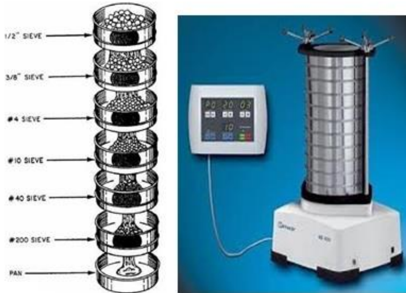
شکل (۲-۲): سری الکها و دستگاه لرزاننده جهت تفکیک دانه ها
