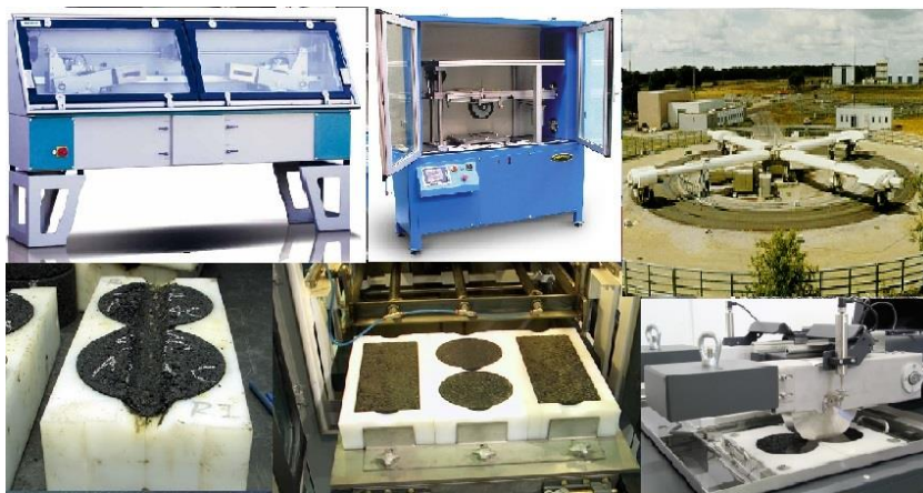
شکل (۴-۱۶): انواع نمونه و تجهیزات آزمایش شیارافتادگی
