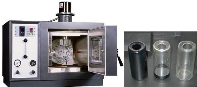
شکل (۱-۱۳): دستگاه آزمایش لعاب نازک قیر دورانی
