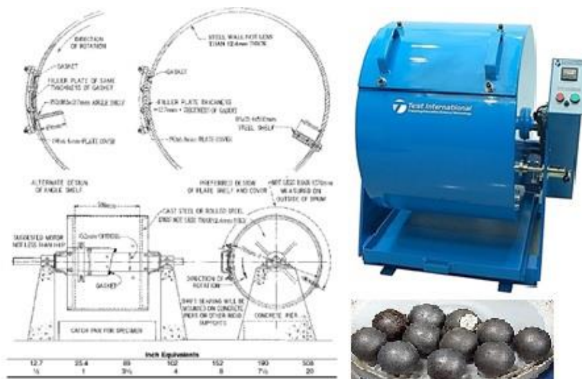
شکل (۲-۴): شکل شماتیک از دستگاه سایش لس آنجلس
