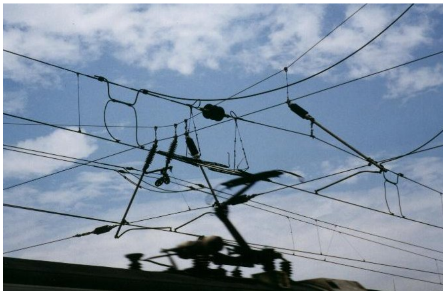
شکل ۱۸-۵- عایق بین هادیهای بالاسری در دو قسمت مجاور در حضور پانتوگراف
