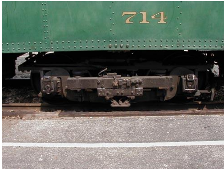
شکل ۶-۵ کفشک نگهدار لکوموتیو با اتصال از بالا
