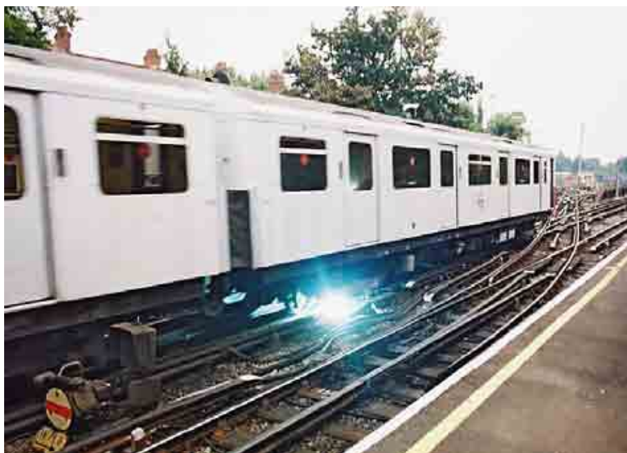
شکل ۶-۲۱- جرقه روی جاربک در انتهای یک سکشن از ریل سوم
