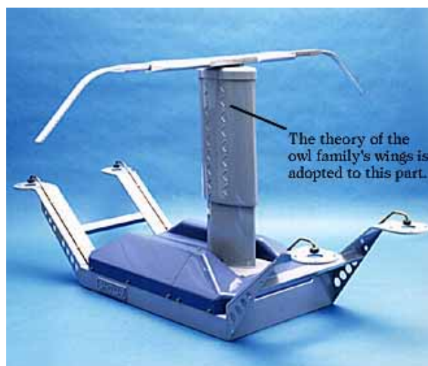
شکل ۴-۹- پانتوگراف بالی شکل
