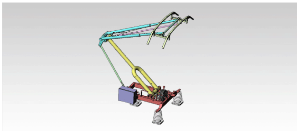
شکل ۱۵-۴ نمای ظاهری پانتوگراف مدل EL-YP200G (۲۰۰ km/hr)
