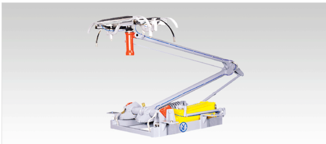
شکل ۴-۱۶ نمای ظاهری پانتوگراف قطار سریع السیر (۳۵۰ km/hr)
