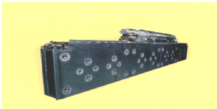
الف- شکل برش خورده مغناطیس ابر رسانا
