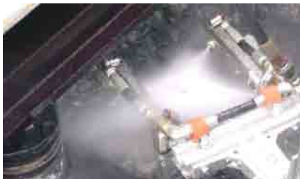
شکل ۶-۲۶- تمیز کردن ریل سوم بدون تماس
