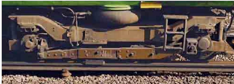
شکل ۶-۶ نحوه قرار گرفتن کفشک روی ریل در نوع تماس از بالا
