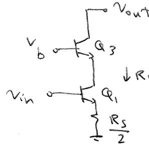
$$R_1 = g_{m1} r_{o1} \left( \frac{R_s}{2} \parallel r_{\pi 1} \right) + r_{o1} + \frac{R_s}{2} \parallel r_{\pi 1}$$
