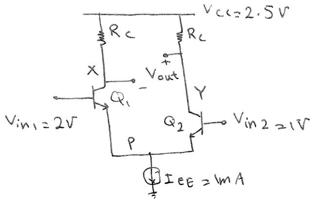
$$V_X \geq V_{in1} \Rightarrow V_X \geq 2 \Rightarrow V_{CC} - R_C I_{EE} \geq 2$$
