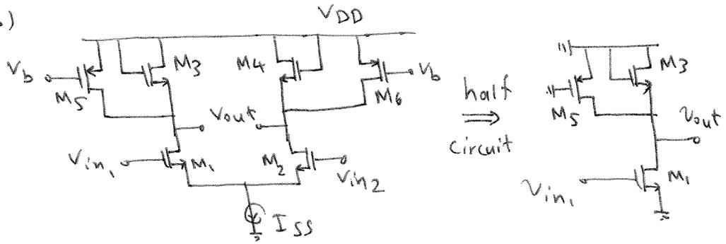
$$A_v = -g_{m1} (r_{o1} \parallel r_{o5} \parallel \frac{1}{g_{m3}} \parallel r_{o3})$$
