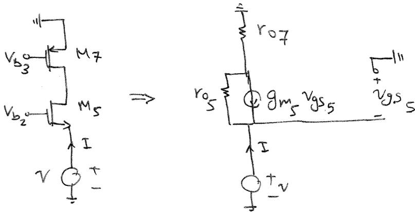
$$v_{gs5} = -v \rightarrow g_{m5} v_{gs5} = -g_{m5} v$$
