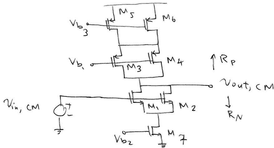
$$R_P = 2g_{m3} \frac{r_{o3}}{2} \frac{r_{o5}}{2} + \frac{r_{o3}}{2} + \frac{r_{o5}}{2} \approx \frac{g_{m3} r_{o3} r_{o5}}{2}$$
