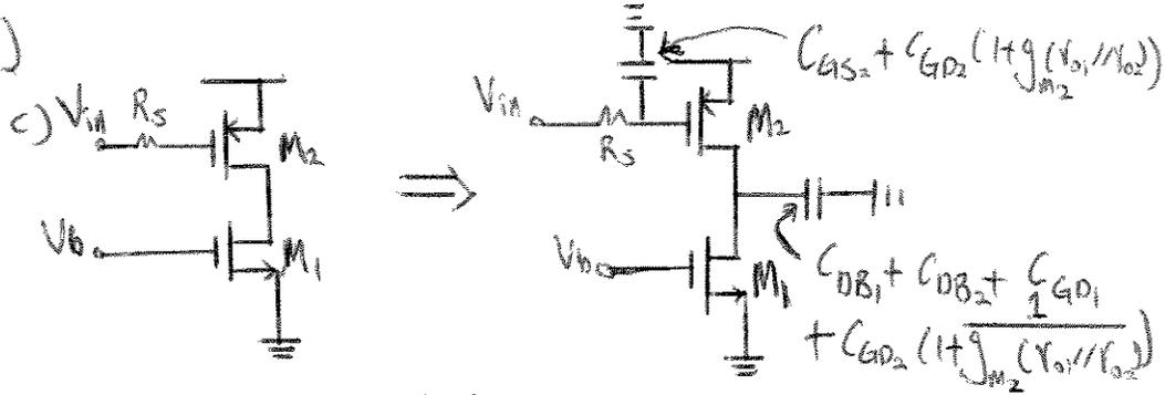
DC gain:  $-g_{m2} (r_{o1} // r_{o2})$
