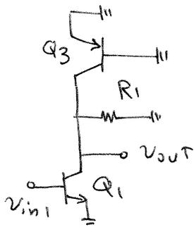
$$A_v = -g_{m_1} (R_1 \parallel r_{o_1} \parallel r_{o_3})$$
