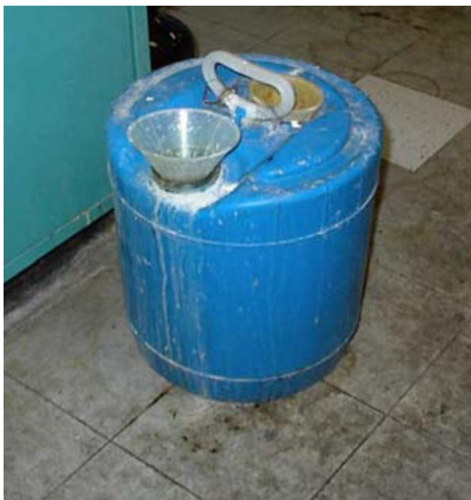
شکل ۷- باقیماندن قیف در دهانه باز ظروف پسماندهای شیمیایی خطرناک
