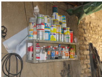
نمونه نامناسب نگهداری ترکیبات شیمیایی
