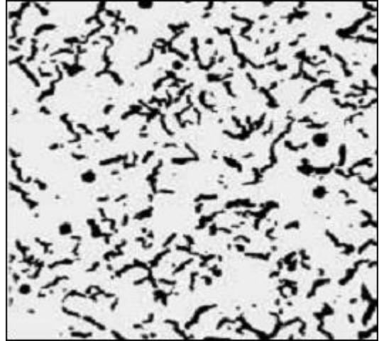
شکل 1: شکل گرافیت های فشرده با 10 % کرویت در متالوگرافی
