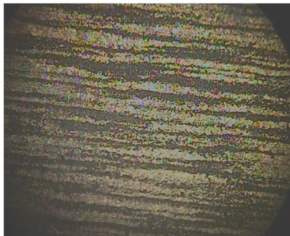
مربوط به بزرگ نمایی کم وسط چرخ دنده ست. که کربن نداده شده است. یک سری به حالت راه راه مشاهده می شود چرا که در شکل دهی چرخ دنده در عملیات فورجینگ برای استحکام، سنبه با فرم فورج، پرلیت (تیره) را در یک جهت و فریت (تیره) را در جهت دیگر، چون دو فاز با استحکام های متفاوت هستند را، ردیف می کند. کشیده شدن دانه ها در یک جهت نشان از فورج شدن قطعه دارد. شایان ذکر است که چرخ دنده ها علاوه بر فورج (مانند آنچه بر قطعه بالا اعمال شده است) با ماشین کاری نیز ساخته می شوند
