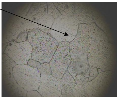
با بزرگنمایی از میکروسکوپ، که تیرگی و روشنی ها قابل مشاهده است به بررسی نمونه می برداریم . خط های اضافه ای سرتاسری که دیده می شود مربوط به پولیش می باشد .
