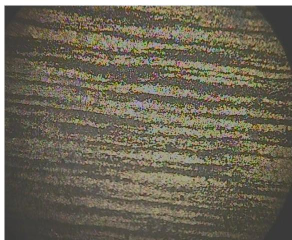
مریوط به بزرگ نمایی کم و سط چرخ دنده است. که کرین نداده شده است. یک سری به حالت راه مشاهده می شود چرا که در شکل دهی چرخ دنده در عملیات فورجینگ برای استحکام، سنبه با فرم فورج، پرلیت (تیره) را در یک جهت و فربت (تیره) را در جهت دیگر، چون دو فاز با استحکام های متفاوت هستند را، ردیف می کند. کشیده شدن دانه ها در یک جهت نشان از فورج شدن قطعه دارد . شایان ذکر است که چرخ دنده ها علاوه بر فورج(مانند آنچه بر قطعه بالا اعمال شده است) با ماشین کاری نیز ساخته می شوند
