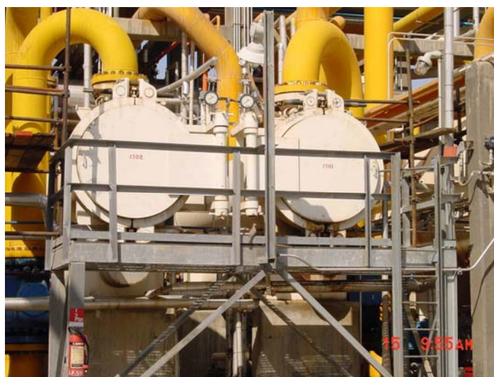
شکل ۸-۲: فیلتر ترش (سمت راست)، فیلتر شیرین (سمت چپ)
